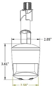
**MS180S** Détecteur interrupteur (SMS)
