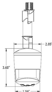
**MS180DIM** Détecteur-gradateur intelligent (DMS) 0 à 10 V
