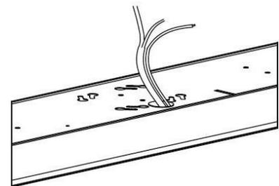
5. Poussez/tirez le dispositif pour le mettre en place et serrez les vis.
